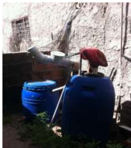
Figura 1-Tambores para produção de biofertilizantes localizado no quintal da residência. Fonte: Autoria própria, 2014.
